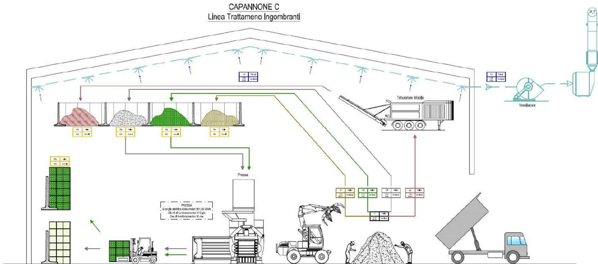
**Figura 6: Schema di flusso Linea C: Trattamento ingombranti e R.A.E.E. (18.102.SA1.AIA-20.2 – Allegato Y.6b - Schema generale a blocchi Stato "Definitivo" – Linea trattamento Ingombranti e R.A.E.E.)**
