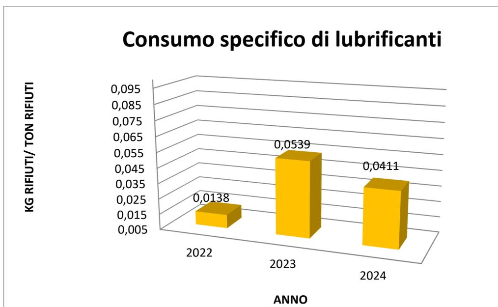
Tutte le attrezzature e gli impianti sono stati sottoposti nel 2023 ad un'attività di manutenzione straordinaria, che hanno causato di conseguenza un incremento del consumo di olio lubrificante rispetto al 2022. Nel 2024 è rimasto invece pressoché costante, sia in termini di consumo assoluto che di consumo specifico.
